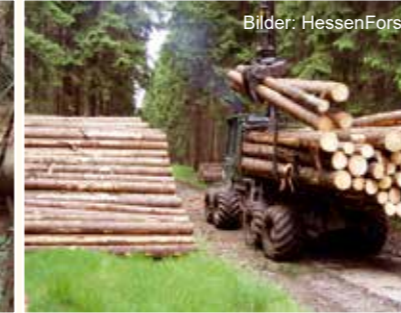
Das Holz wird mit Spezialfahrzeugen (sogenannte FORWARDER) am Wegrand gestapelt für den späteren Abtransport mit dem LKW.
