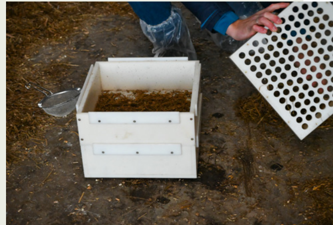
Abb. 64: Das Obersieb der Schüttelbox wird geleert
