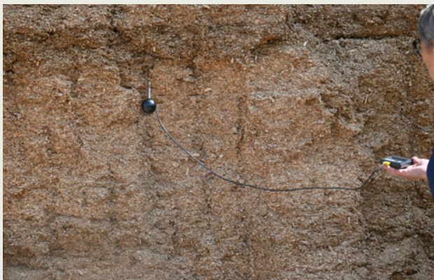
Abb. 43: Temperaturmessung am Silostock
