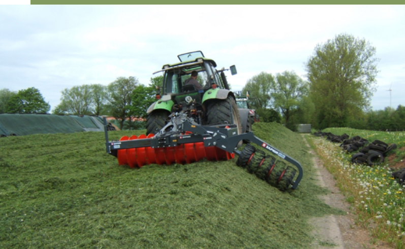
Abb. 50: Eine schnelle und gleichmäßige Verteilung des Siliergutes ist Voraussetzung für eine gute Verdichtung. Auf ein ausreichend hohes Walzgewicht ist zu achten!
